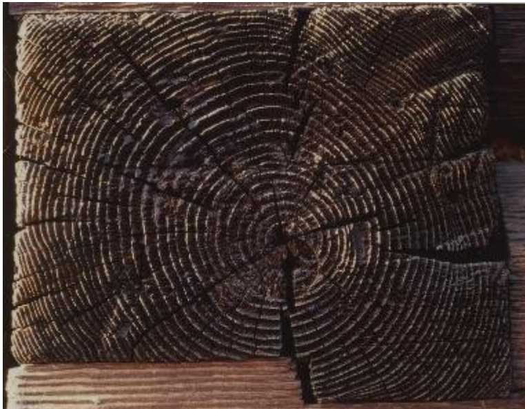
Obr. 7.1. Drevo zostarnuté pôsobením UV žiarenia.
