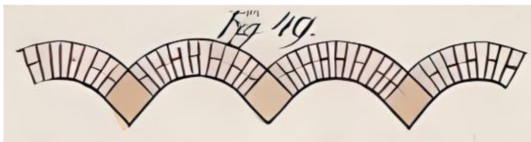
Obr. 4.24. Murovaný klenbičkový strop hradu Oldersum.
