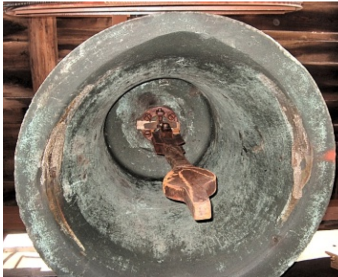
57. Poprad-Spišská Sobota (okr. Poprad), kampanila: zvon z poslednej štvrtiny 14. storočia, dielňa majstra Konráda a jeho nasledovníkov v Spišskej Novej Vsi Nerovnomerné opotrebovanie úderového venca v širokom páse bolo spôsobené nesprávnym závesom zvona a nevyváženým srdcom bijúcim mimo os kyvu zvona. Zároveň je to ukážka dôsledkov nevhodného pohonu rotačným elektromotorom, aplikovaného na pamiatkovo chránený zvon.
